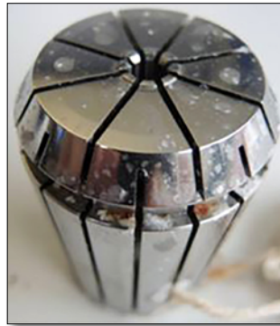
REGO-FIX Stainless Steel ER Collet / Material: DIN 1.4122
